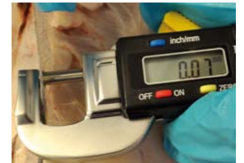
Fig. 3: Måling av svarthinns tykkelse
